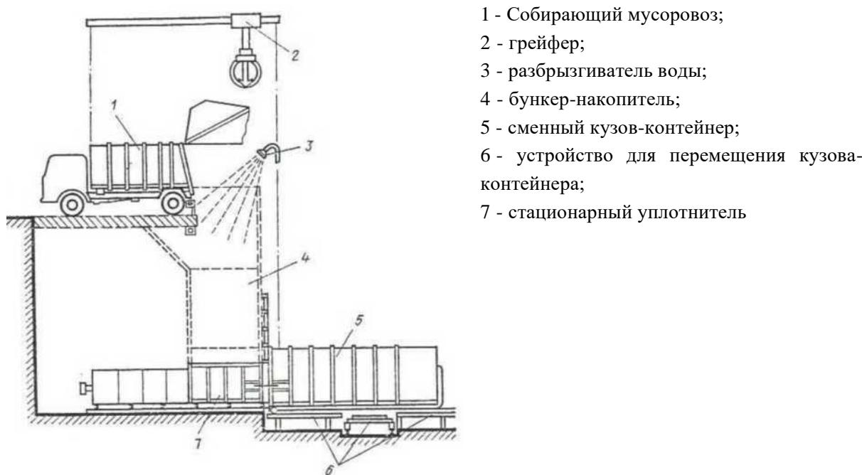
Рисунок 5.21. Схема мусороперегрузочной станции с прессованием ТБО стационарным уплотнителем.
