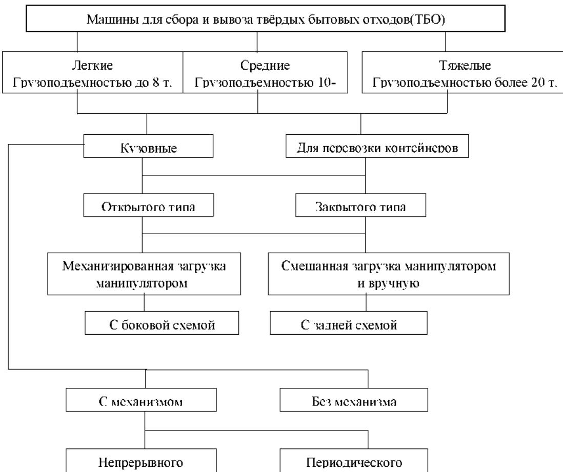
Рисунок 5.23. Классификация машин для сбора и вывоза ТБО.
