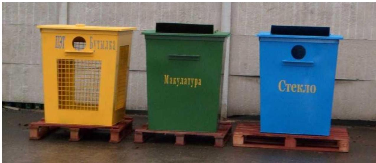
Рисунок 5.5. Контейнер К-0,75 с крышкой, доработанной для раздельного сбора отходов.
