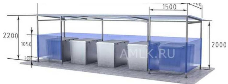
Рисунок 5.15. Устройство контейнерной площадки на 5 контейнеров (вариант 2).
