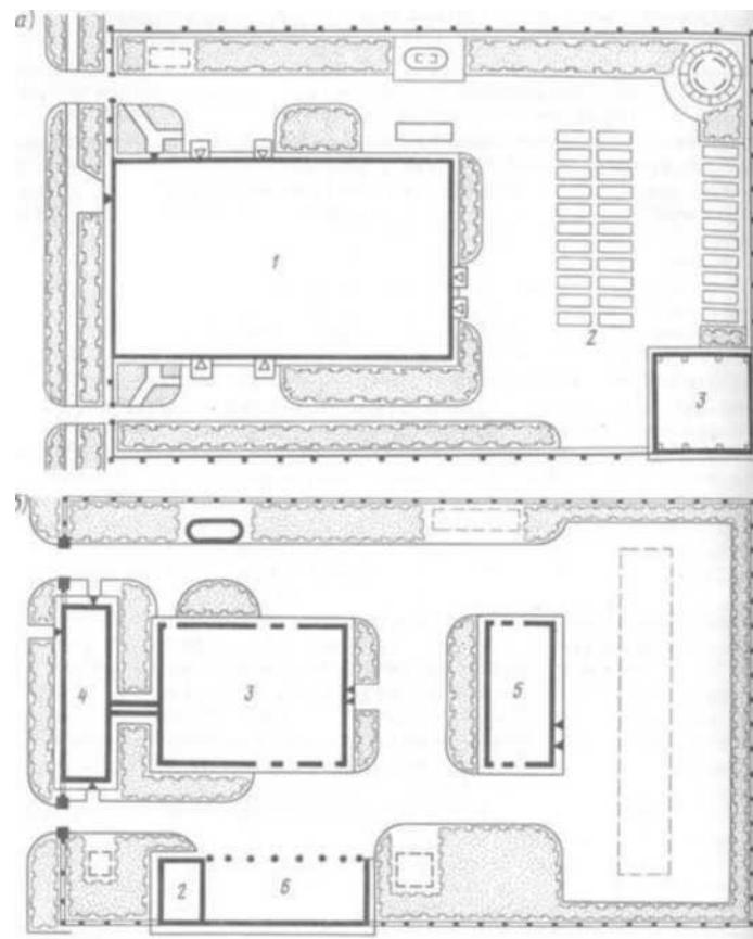
*Рисунок 7.1. Генеральный план базы на 50 и 100 машин.*
