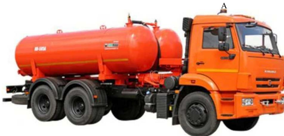
Рисунок 6.2. Вакуумная машина КО-505А.
