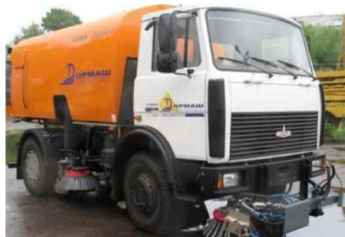
*Рисунок 7.7. Вакуумная подметально-уборочная машина ВПМД-01.*
