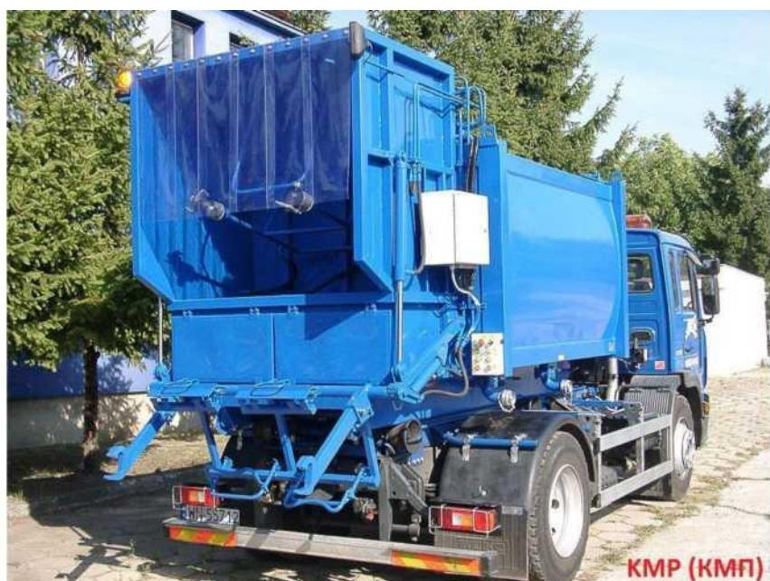
Рисунок 5.18. Спецмашина для мойки контейнеров Haller.
