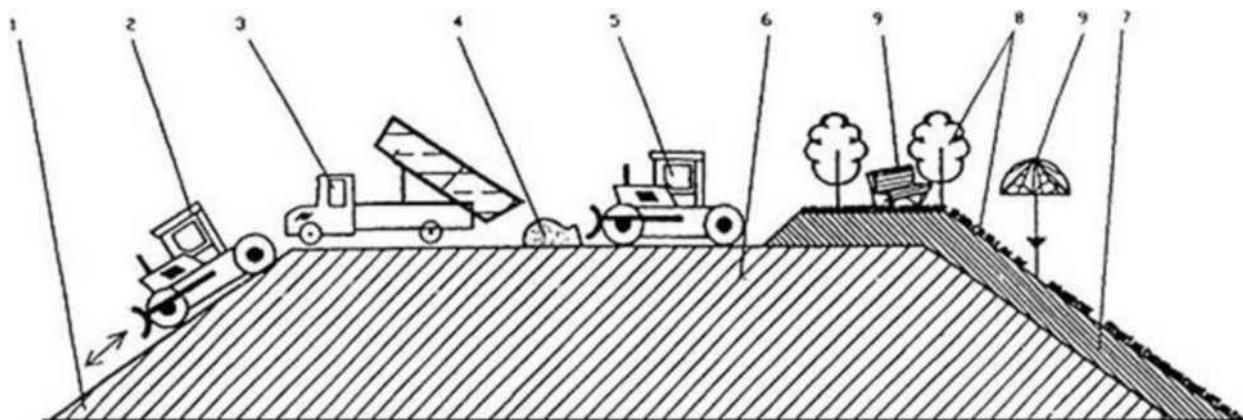
Рисунок 5.31. Технологическая схема рекультивации закрытых свалок без переработки свалочного грунта.
