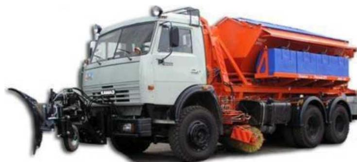
Рисунок 7.8. Комбинированная машина МКДС-4705.
