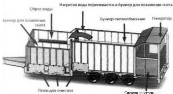
Рисунок 7.4. Схема работы снегоплавильной установки.
