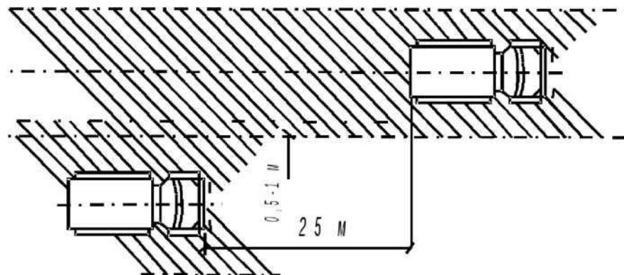
Рисунок 7.3. Схема поливки дорожных покрытий.
