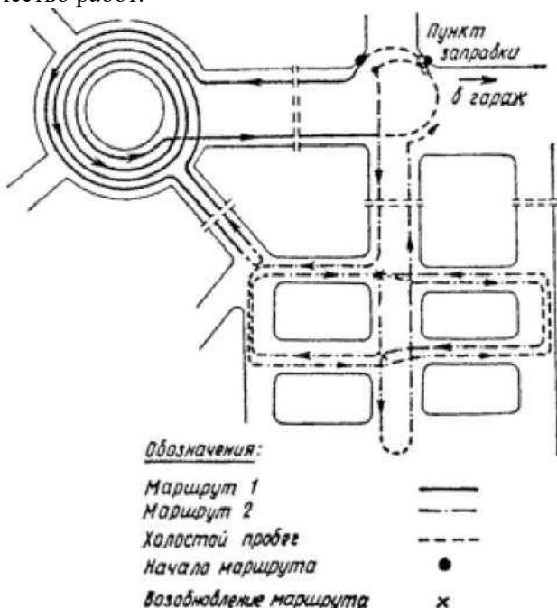
Рисунок 7.1. Образец маршрутной карты работы подметально-уборочных машин.
