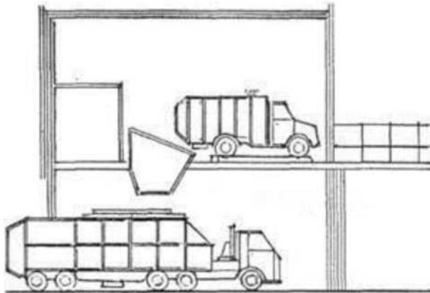
Рисунок 5.22. Двухуровневая МПС с уплотнением ТБО в транспортном большегрузном мусоровозе
